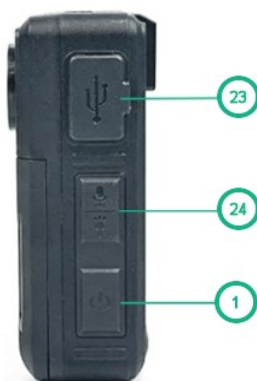
Рисунок 2.1 - Внешний вид Видеорегистратора, расположение кнопок управления, светодиодных индикаторов и дисплея,
