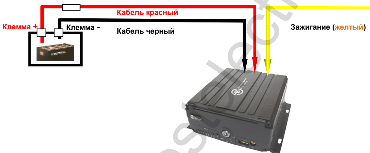
Рисунок 2.1 - Схема подключения электропитания к Видеорегистратору
