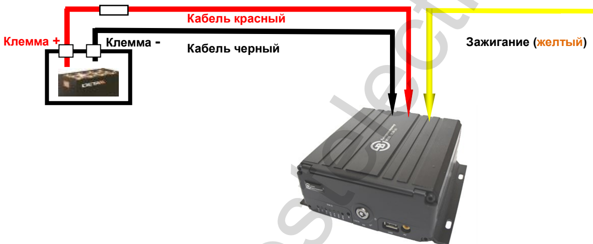
Рисунок 2.1 - Схема подключения электропитания к Видеорегистратору
